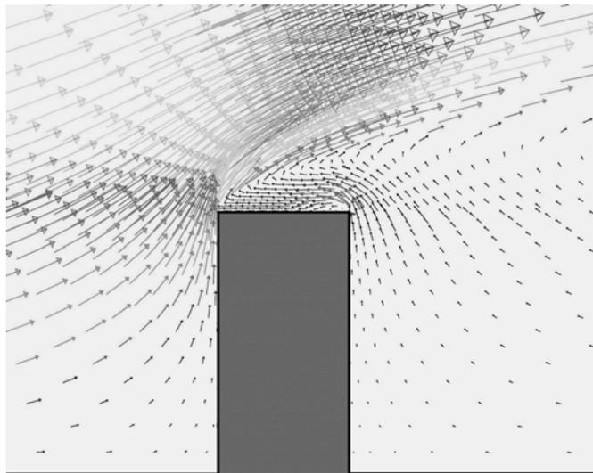
*Figura 1: Vectores de la velocidad del viento generada en el entorno del edificio (modelo 2D).*
