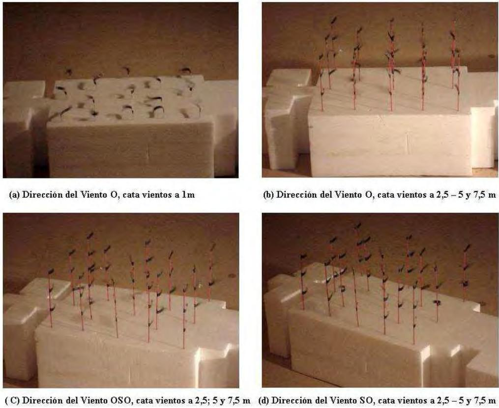
Figura 6: (a) Catavientos a 1m sobre el techo con viento desde el Oeste; (b) catavientos a tres alturas sobre el techo con viento desde el Oeste; (c) catavientos a tres alturas sobre el techo con viento desde el Oeste Sur Oeste; (d) catavientos a tres alturas sobre el techo con viento desde el Sur Oeste.
